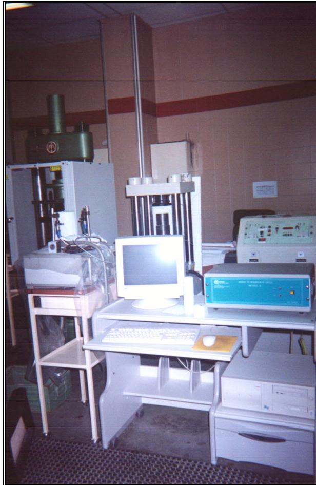
Foto 94.- Equipo informático de procesamiento de datos durante los ensayos de compresión asociado a la prensa
