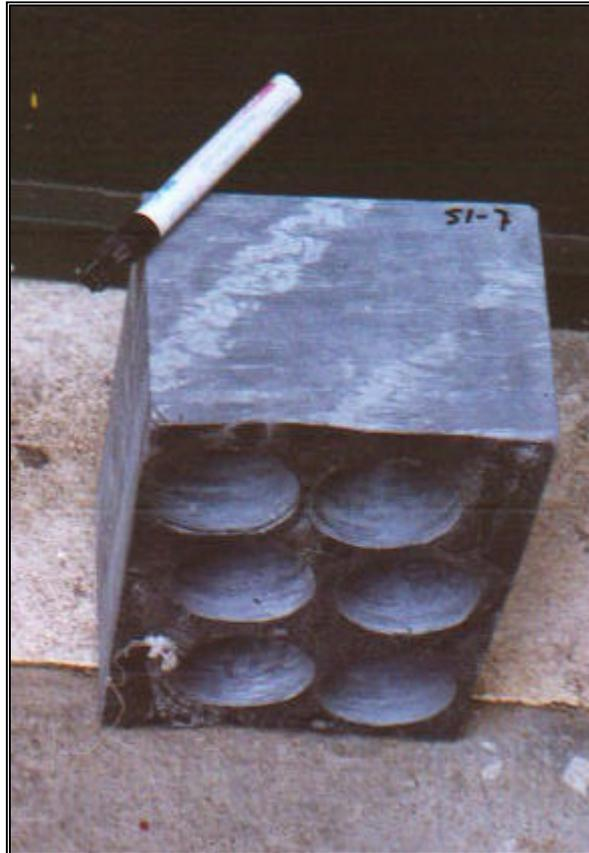
Foto 11.- Bloques tallados para probetas de pizarras con laminaciones de areniscas
