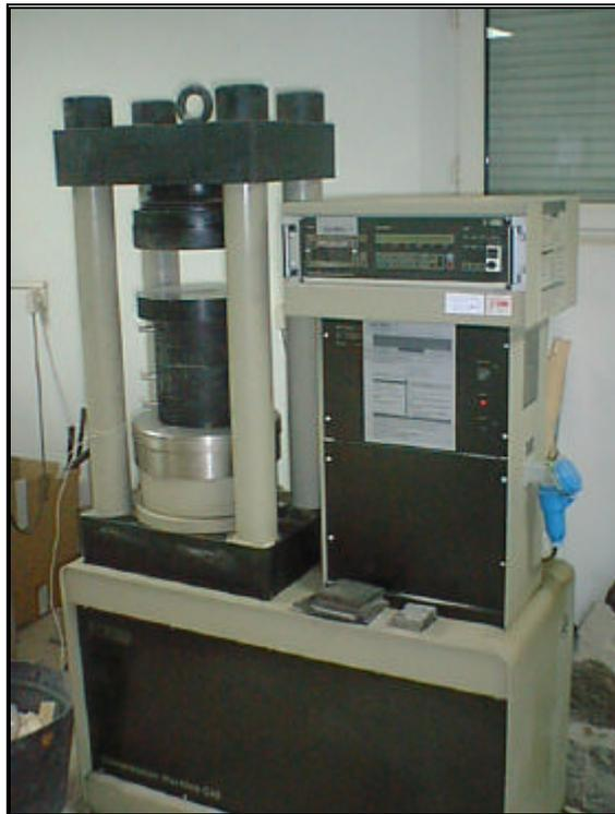
Foto 92 - Prensa universal de rotura de rocas a compresión
