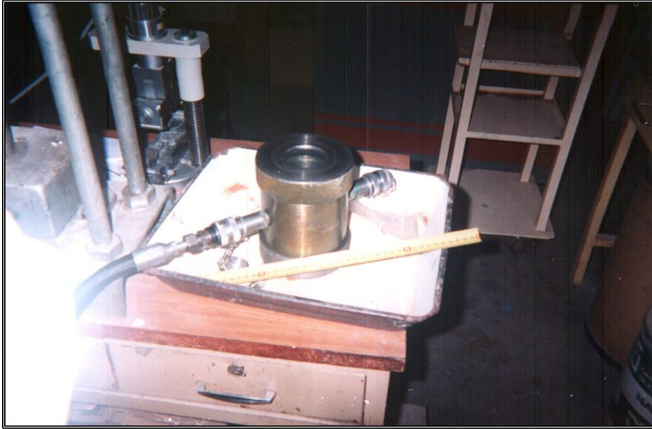
Foto 93.- Célula empleada para la compresión triaxial
