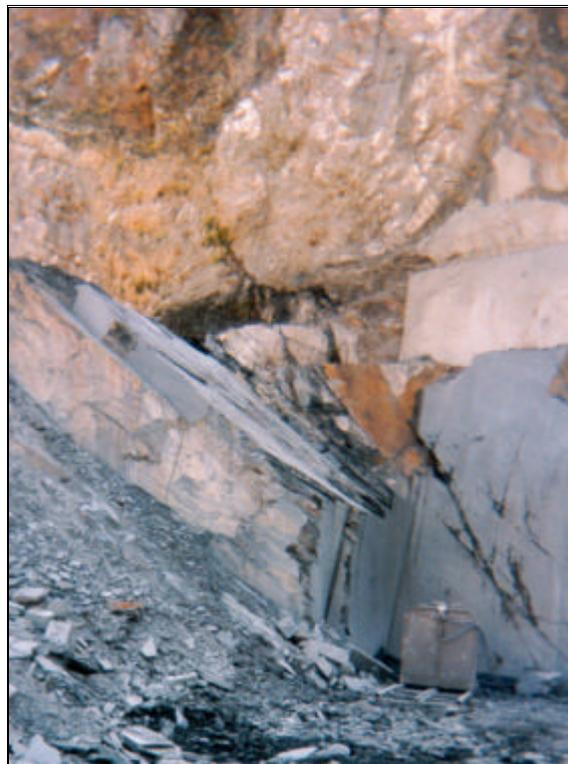
Foto 3.- Corte de rocas mediante hilo diamantado
