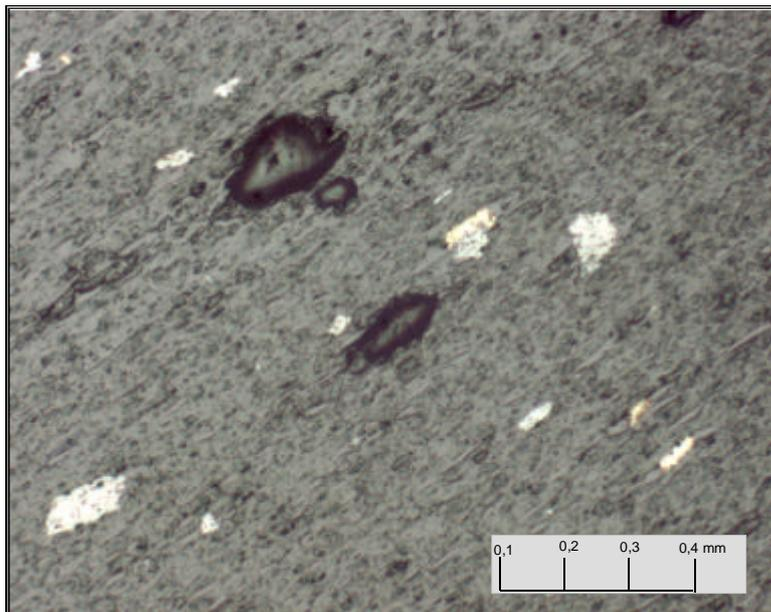
Foto 82.- Muestra C2-pp-01, magnetita y calcopirita, sección normal a la foliación
